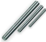
Utilizadas en construcción para montaje de soportes o sistemas de bandejas de escaleras para la conducción de cables. fabricada en acero bajo carbono (sae j-429). acero grado 2 para mayor resistencia mecánica. diámetro 1/2pg x 1 mts. empaque plástico x 10 unidades.
