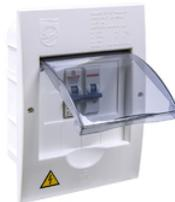
Tablero plástico para breaker enchufable de 2 circuitos a 220v. color blanco. tiene una capacidad de corriente nominal de 80 amperios y máxima corriente de ruptura de 10 ka. ideal para acometida con conductores en cobre y aluminio. cumple con norma retie. referencia 730000b de ciles.
