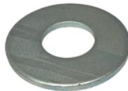
Accesorio utilizadas en construcción para montaje de soportes o sistemas de bandejas de escaleras para la conducción de cables. fabricada en acero bajo carbono (sae j-429). acero. diámetro agujero 3/16 pulgadas. empaque plástico x 50 unidades.
