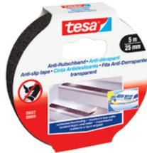
Cinta con soporte de pvc y tejido recubierto de abrasivo, resistente al agua marina, limpiadores, altas temperaturas y rayos ultravioleta. es la mejor opción en protección y prevención de deslizamientos en zonas de alto riesgo donde se requiera dar pasos seguros.
