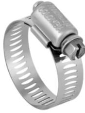
Abrazadera de cremallera y ajuste por tornillo sin fin en acero inoxidable, banda de 12,7 mm, tornillo de 5/16" y torque máximo de 80 lb por pulgada.
