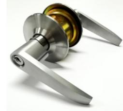
Cerradura cilíndrica para entrada principal con acabado inox, cilindro en zamak, centro de instalación de 60mm (2-3/8"), 3 llaves en acero con acabado niquelado. diámetro de roseta de 65mm, para puertas con espesor de 35 a 50mm.
