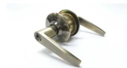
Cerradura cilíndrica para alcoba con acabado bronce antiguo, cilindro en zamak, centro de instalación de 60mm (2-3/8"), 3 llaves en acero con acabado niquelado. diámetro de roseta de 65mm, para puertas con espesor de 35 a 50mm.
