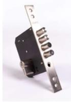
Cerradura auxiliar de incrustar para uso en puertas batientes en entrada principal, centro de instalación a 50 milímetros, con 4 bulones fabricados en acero endurecido. contiene cilindro 30+30 milímetros de llave por ambos lados y accesorios para instalación.
