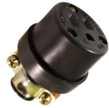
Aislantes eléctricos de cauchocontactos de cobre doblegrapas de sujeción para los cablesabrazadera de seguridadtensión de uso: máximo 150 voltioscapacidad de corriente: 15 amperiosusos: en herramientas eléctricas de trabajo pesadounidad de empaque: caja 360 unidadesub-empaque: bolsa 12 unidades...
