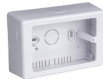
Caja para sobreponer 2x4 pulgadas para canaleta, fabricada en abs material libre de halogenos, con grado de proteccion uv superior para conservacion del color blanco, se utiliza para montar aparatos como interruptores, tomacorrientes. acceso para tuberia de 1/2" y canaletas estandar 10x10 - 20x12,...
