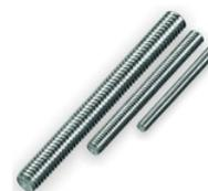
Utilizadas en construcción para montaje de soportes o sistemas de bandejas de escaleras para la conducción de cables. fabricada en acero bajo carbono (sae j-429). acero grado 2 para mayor resistencia mecánica. diámetro 5/16p x 1 mts. empaque plástico x 25 unidades.
