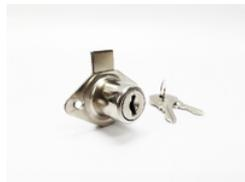
Cerradura para mueble para espesores hasta 25 mm; acabado niquelado; contiene 2 llaves; centro de instalación 20 mm; su instalación puede ser remachada; soldada o atomillada; agujero para la instalación de 7/8".
