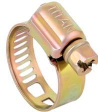
Abrazadera de cremallera y ajuste por tornillo sin fin en acero al carbón con recubrimiento de zinc, banda de 8 mm, tornillo de 1/4" y torque máximo de 30 lb por pulgada.
