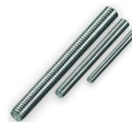
Utilizadas en construcción para montaje de soportes o sistemas de bandejas de escaleras para la conducción de cables. fabricada en acero bajo carbono (sae j-429). acero grado 2 para mayor resistencia mecánica. diámetro 1/4p x 1 mts. empaque plástico x 25 unidades.
