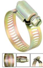
Abrazadera en acero al carbon. tornillo sin fin con cabeza hexagonal de 8mm para destornillador de punta pala y copa. grapa reforzada de calibre 1.1. mm. ancho de fleje 12.7 mm. 100% acero al carbon.
