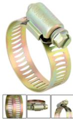
Abrazadera en acero al carbon w1 tornillo sin fin con cabeza hexagonal de 8mm para destornillador de punta pala y copa. grapa reforzada de calibre 1.1. mm ancho de fleje 12.7 mm. 100% acero al carbon.
