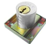
Cerradura 113/30 - 35 - 40, con diseño de sobreponer para muebles de madera principalmente. acabado niquelado y cobre. longitud de 30 mm. cilindro en latón macizo de cuatro pines, porta cilindro niquelado o latón puro, pintado con laca transparente brillante y cuerpo en cold rolled con recubrimie...
