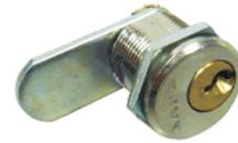
Cerradura 114 ni, para guantera. grupo del cilindro en latón macizo. llaves en latón intercambiables, con 225 combinaciones aproximadamente. el giro del pasador es de 90°, la llave sólo entra en posición cerrada. porta cilindro niquelado, tuerca para ajustar dependiendo del espesor de la puerta...
