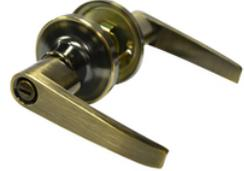
Cerradura manija baño, tubular, acabado bronce antiguo, cilindro en latón, centro de instalación ajustable (60mm - 70mm), ansi grado 3, para puertas con espesor entre 35mm (1-3/8") y 45mm (1-3/4")
