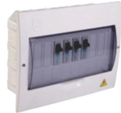
Tablero plástico para breaker enchufable de 6 circuitos a 220v. color blanco. tiene una capacidad de corriente nominal de 80 amperios y máxima corriente de ruptura de 10 ka. ideal para acometida con conductores en cobre y aluminio. dimensiones de la caja en mm: 269x211x70. cumple con norma reti...
