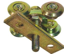
Fabricado en acero 12114 importado con un diametro de 15/16 en sus ruedas y un sistema de buje interno en nylon que la hace mas suave y silenciosa.
