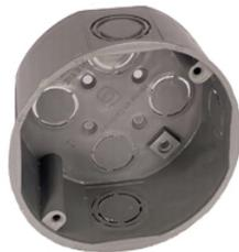
Caja octogonal fabricada en polipropileno material libre de halogenos, bordes y fijacion de tornillos reforzados. entrada para tuber3a de 1/2" y 3/4", knockput f3ciles de retirar, tiene mayor capacidad interna. cumple retie. para uso en instalaciones el3ctricas en general. referencia 144016 de ci...
