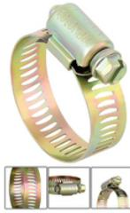
Abrazadera power tech acero al carbon. tornillo sin fin con cabeza hexagonal de 8mm para destornillador de punta pala y copa. grapa reforzada de calibre 1.1. mm. ancho de fleje 12.7 mm. 100% acero al carbon.
