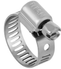
Abrazadera de cremallera y ajuste por tornillo sin fin en acero inoxidable, banda de 8 mm, tornillo de 1/4" y torque máximo de 25 lb por pulgada.
