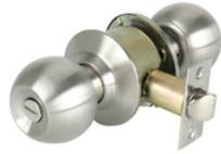
Cerradura cilíndrica para baño con acabado inox, centro de instalación de 60mm (2-3/8"), 3 llaves en acero con acabado niquelado. diámetro de roseta de 65mm, para puertas con espesor de 35 a 50mm.
