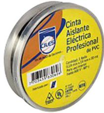
Cinta aislante eléctrica de pvc para uso profesional en trabajos de baja tensión y en interior. soporta hasta 600v a 80°C. medidas: 0,19mm x 18mm x 20 mts. cumple retie. color negro. referencia 842306 de ciles.
