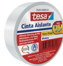
Cinta aislante color blanco, de pvc con certificación retie, ideal para pequeños trabajos eléctricos, resistente al agua, oxidación rayos uv y frío resistente hasta 80c de excelente capacidad dieléctrica.
