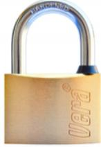
Candado plano con bloque en latón, arco de acero endurecido y niquelado. diseño de dos columnas y dos llaves. es necesario utilizar la llave para cerrarlo.
