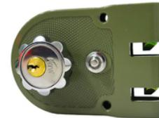
Cerradura de sobreponer tipo chapa-candado para puertas con apertura hacia afuera o corredizas. centro de instalación de 60 mm. incluye platina de refuerzo para instalación con soldadura. permite ser instalada en puertas de espesor entre 35 mm (1-3/8") - 55 mm (2-1/8"). contiene tres llaves. cil...
