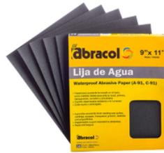
Corte rápido y prolongado, papel resistente a la fricción, evita el embotamiento del grano al sumergir la lija en agua, impermeabilidad y resistencia a la humedad. para lijado en húmedo y en seco multipropósito y la industria automotriz. grano carburo de silicio para alto rendimiento. pliego 9 x ...
