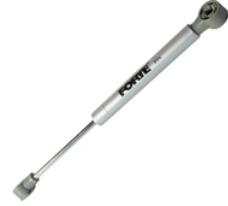
Fabricados en acero y plÃ1stico. alta resistencia mecÃ1nica segÃ1n altura y peso de la puerta. ciclos de apertura 17.000. recubrimiento electrolÃ1tico, para mayor resistencia a la corrosiÃ3n. anclaje rÃ1pido. ejerce una fuerza de 80 n. utilizado en muebles de hogar y de exhibiciÃ3n.
