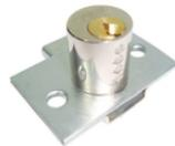
Cerradura 111 niquelada, de sobreponer para muebles metálicos, cilindros en latón macizo de cuatro pines, porta cilindro en latón y cuerpo en cold rolled con recubrimiento galvanizado, homologación de llaves.
