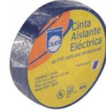
Cinta aislante eléctrica de pvc para uso profesional en trabajos de baja tensión y en interior. soporta hasta 600v a 80°C. medidas: 0,18mm x 18mm x 15 mts. cumple retie. color azul. referencia 842307a de ciles.
