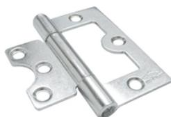
Fabricada en lamina de acero cold rolled. un solo pasador el cual se puede colocar en ambos lados de la bisagra segun la necesidad. no necesita elaborar caja, ya que las alas se alojan una dentro de la otra.
