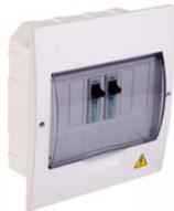
Tablero plástico para breaker enchufable de 4 circuitos a 110v. color blanco. tiene una capacidad de corriente nominal de 80 amperios y máxima corriente de ruptura de 10 ka. ideal para acometida con conductores en cobre y aluminio. dimensiones de la caja en mm: 197x211x70. cumple con norma reti...
