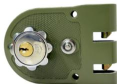
Cerradura de sobreponer tipo chapa-candado para puertas con apertura hacia adentro o corredizas. centro de instalación de 60 mm. incluye platina de refuerzo para instalación con soldadura. permite ser instalada en puertas de espesor entre 35 mm (1-3/8") - 55 mm (2-1/8"). contiene tres llaves. cil...
