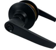
Cerradura cilíndrica para entrada principal, acabado con pintura electrostática color negro, cilindro en zamak, centro de instalación de 60mm (2-3/8"). posee 3 llaves en acero con acabado niquelado. diámetro de la roseta de 65mm. utilizado en puertas con espesor de 35 a 50mm."
