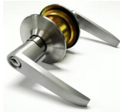
Cerradura cilíndrica para alcoba con acabado inox, cilindro en zamak, centro de instalación de 60mm (2-3/8"), 3 llaves en acero con acabado niquelado. diámetro de roseta de 65mm, para puertas con espesor de 35 a 50mm.
