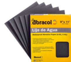
Corte rápido y prolongado, papel resistente a la fricción, evita el embotamiento del grano al sumergir la lija en agua, impermeabilidad y resistencia a la humedad. para lijado en húmedo y en seco multipropósito y la industria automotriz. grano carburo de silicio para alto rendimiento. pliego 9 x 11"
