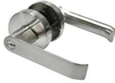
Cerradura manija baño, tubular, acabado acero inoxidable, cilindro en latón, centro de instalación ajustable (60mm - 70mm), ansi grado 3, para puertas con espesor entre 35mm (1-3/8") y 45mm (1-3/4")
