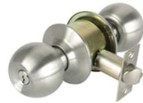
Cerradura cilíndrica para alcoba con acabado inox, cilindro en zamak, centro de instalación de 60mm (2-3/8"), 3 llaves en acero con acabado niquelado, diámetro de roseta de 65mm, para puertas con espesor de 35 a 50mm.
