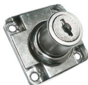
Cerradura 1550 nuovo, acabado niquel brillante. para gabinetes, guanteras, vitrinas, muebles y escritorios; permite ser usada en puertas de ala corredizas, cilindro de guardas, dos llaves simÃ©tricas con protector plÃ¡stico. material: lÃ¡mina de acero y cilindro en zamak
