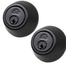
Cerrojo de seguridad doble con dos cilindros (llave-llave). acabado pintura negra, para puertas con espesores entre 35 y 50mm. distancia de instalación al canto de la puerta (backset) ajustable a 60 Å 70mm. se acciona con llave desde el interior y el exterior.
