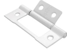
Fabricada en lamina de acero cold rolled, para usar en carpintería de madera y aluminio, con un solo pasador el cual se puede colocar por ambos lados de la bisagra según la necesidad y no necesita elaboración de caja.
