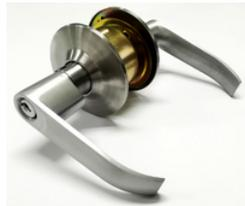
Cerradura cilíndrica para alcoba con acabado inox, cilindro en zamak, centro de instalación de 60mm (2-3/8"), 3 llaves en acero con acabado niquelado. diámetro de roseta de 65mm, para puertas con espesor de 35 a 50mm.
