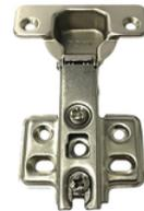
Fabricadas en acero cold rolled, recubrimiento de níquel electro depositado. graduación de altura y profundidad. dimensión 35 mm. Ángulo de apertura 110 grados. espesores de tableros recomendado 15mm - 18 mm. ciclo de apertura y cierre 40.000. capacidad de carga 2.4 kg por par. utilizada en mue...
