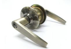
Cerradura cilíndrica para entrada principal con acabado bronce antiguo, cilindro en zamak, centro de instalación de 60mm (2-3/8"), 3 llaves en acero con acabado niquelado. diámetro de roseta de 65mm, para puertas con espesor de 35 a 50mm.
