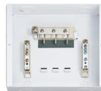
Lamina col roled, partes plasticas en termoplasticos, contactos en aluminio estanado, pintura electrostatica.
